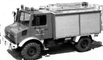
Das TLF ist das Arbeitspferd der Feuerwehren, die ideale Angriffswaffe der ersten Minuten der Brandbekämpfung. Mit der Schnellangriffseinrichtung (30m Druckschlauch) kann der Brand bereits gekämpft werden, während mit den Geräten des LF 8 noch die Löschwasserversorgung aufgebaut wird.
